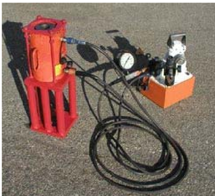
Tijesak (presa) za ispitivanje sidra
